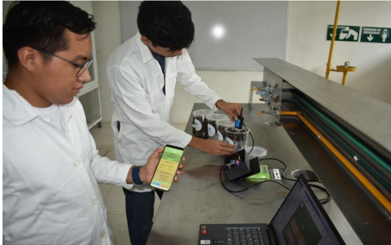
Figura 3. Pruebas de laboratorio: calibración del sensor y medición de NPK utilizando el sistema inteligente de monitoreo de macronutrientes en suelos
