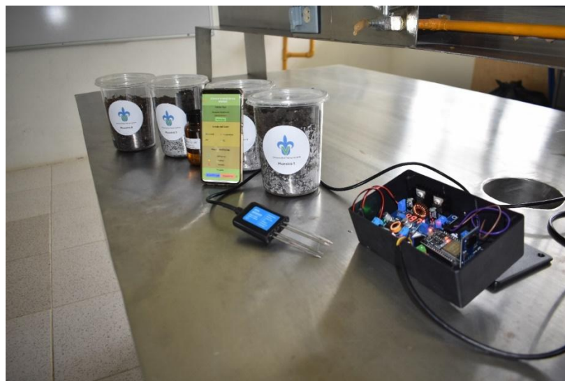
Figura 2. Prototipo del sistema inteligente de medición de nitrógeno, fosforo y potasio
