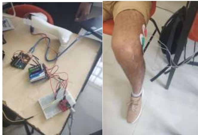
Imagen 5. Terminales de sensores EMG. Nota: Elaboración propia.
