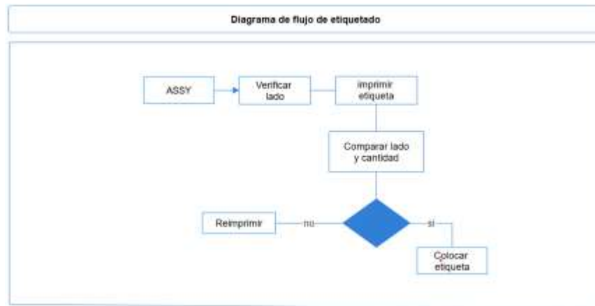
Figura 2. Diagrama de flujo de etiquetado
